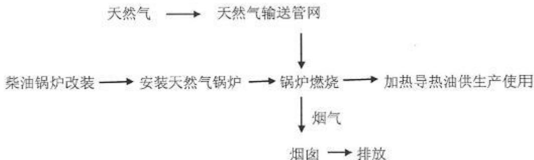
**图 2-1 项目生产工艺流程及产污节点图**
