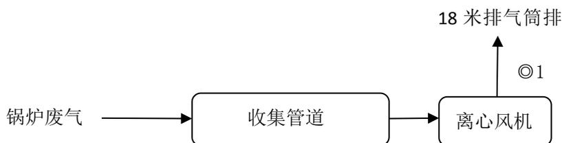
图 6-1 天然气锅炉废气监测点位布置图，◎为采样监测点位
